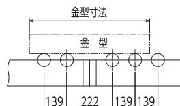
■ 油圧シリンダで金型をリフトアップし、ローラ上を金型質量の約1/100<sup>\*</sup>程度の力で押し引き出来ます。※) 使用条件により異なる場合があります。
